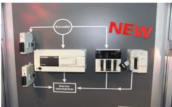
Еще одной премьерой прошедшей выставки стал новый компактный контроллер **FX3U** в комплекте с модулями для управления сервоприводом, впечатляющий своей производительностью. Настройка данной системы сведена к минимуму, поэтому она не потребует глубоких знаний.
