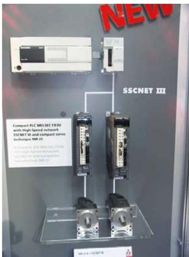
Среди новых разработок Mitsubishi Electric следует отметить и **SSNET** – высокоскоростную сеть, разработанную специально для сложных многоосевых сервосистем Motion Control. Ее основными преимуществами являются: легкость в установке по принципу Plug-and-Play, полный дуплекс со скоростью 50+50=100 Мбит/с., оптоволоконные соединения высокой помехоустойчивости. Кроме того, при необходимости можно использовать модуль **MR-MG30** для стыковки с Profibus.
