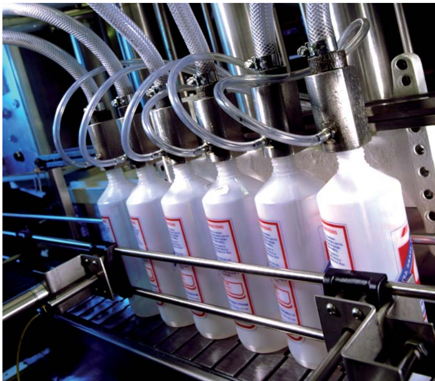
Установки для розлива в бутылки с сервосистемами Мицубиси MR-E снижают стоимость системы
