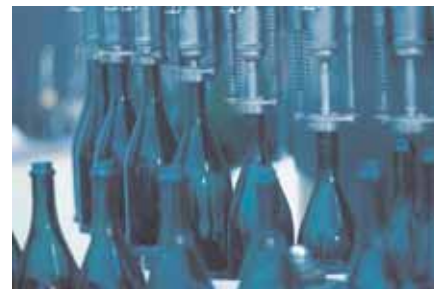
Автоматизированная закрутка бутылок с ограничением крутящего момента
